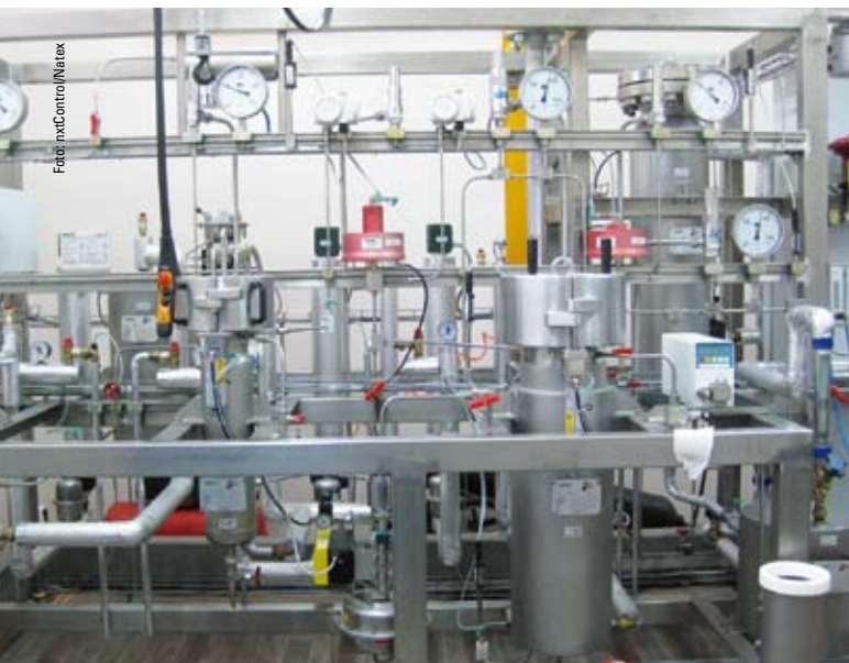
Prüfanlage zum Test von Stahlrohren, die von der nxtControl-Software automatisiert gesteuert wird
