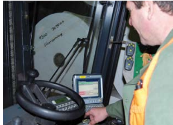
Abholbereite Ware in der Produktion wird beim Verladen mit dem Intermec CV30 Staplerterminal gescannt
